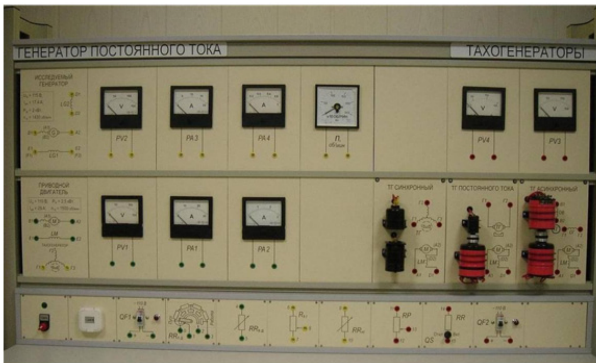
Рис. 2. Приборная панель лабораторного стенда «Генератор постоянного тока» ( http://zei.narod.ru/MPT.html )
