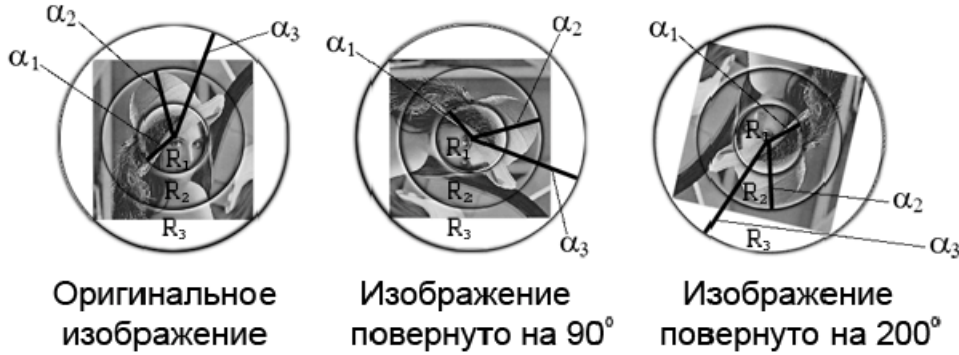
Рис. 2. Фазы моментов \alpha_1 , \alpha_2 , \alpha_3 , вычисленные для разных круговых сегментов R_1 , R_2 , R_3 оригинального изображения и их поведение в случае поворота изображения вокруг фронтальной оси
