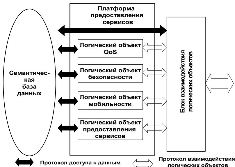
Рис. 2 Архитектура узла, обеспечивающая сервисную функциональность сети
